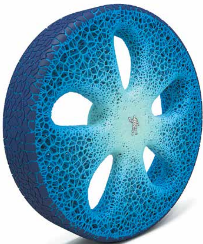
Концепт шины будущего MICHELIN Vision, изготовленной при помощи 3D-печати.
